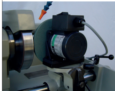
Abrichtgerät für Diamantschleifscheiben Dresser for diamond wheels
