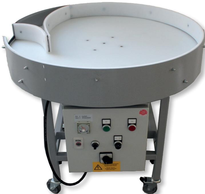
**Die Drehteller der Größen D60 / D80 und D100 sind ideal um eine hohe Oberflächengüte fertiger Drehteile nicht zu beschädigen. Mit wechselbarer POM Platte erhältlich.**
